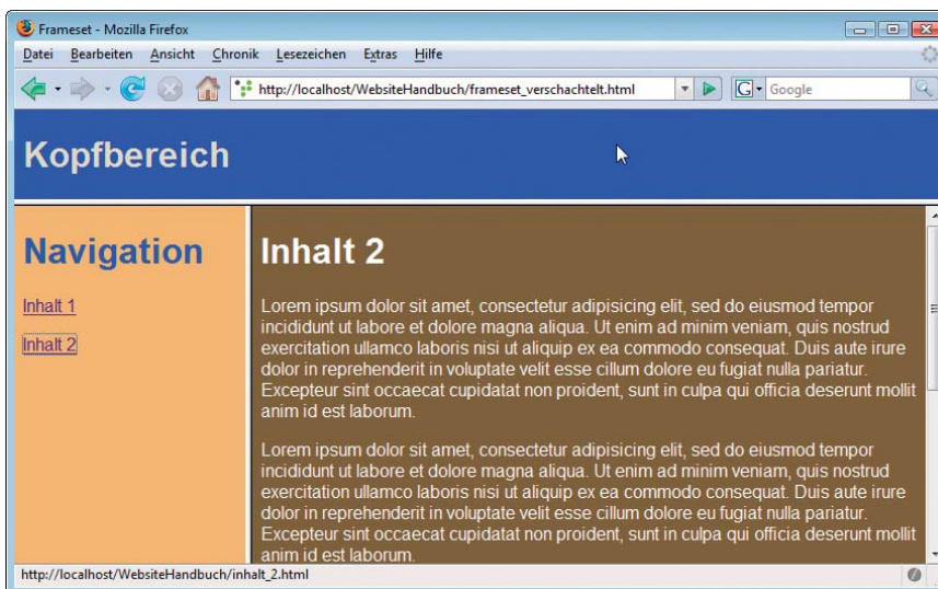
Abbildung 4.72: Durch Klick auf INHALT 2 wird im rechten Bereich eine andere Datei geladen
