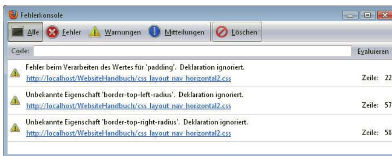
Abbildung 4.92: Die Fehlerkonsole von Firefox zeigt Fehler im CSS-Code
