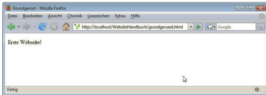
Abbildung 4.3: Das Ergebnis im Browser: Der Seitentitel (Inhalt des Elements title ) erscheint in der Titelleiste
