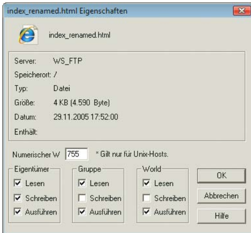
Abbildung 26.6: Die korrekten Berechtigungen für Skripte
