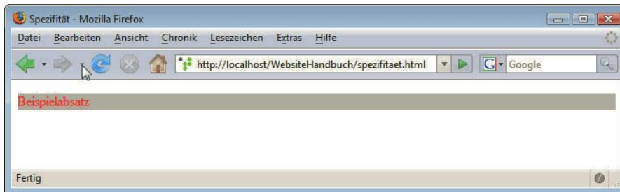
Abbildung 4.21: Bei mehreren sich widersprechenden Angaben setzt sich die spezifischere durch. Im Beispiel ist die Textfarbe des Absatzes rot und die Hintergrundfarbe silbern
