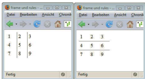
Abbildung 4.58: Links: Linien zwischen den Spalten ( rules="cols" ). Rechts: Linien nur zwischen den Zeilen ( rules="rows" )
