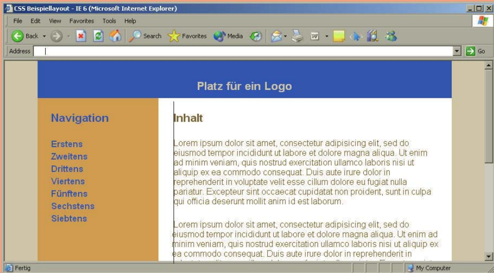
Abbildung 4.84: Schaut man im Internet Explorer 6 ganz genau hin, sieht man, dass der Text neben der Navigation um 3px nach rechts verschoben ist - die schwarze eingefügte Linie verdeutlicht das
