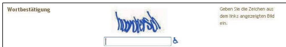
Abbildung 22.4: CAPTCHA, gesehen bei http://www.blogger.com/ . Alternativ zum visuellen CAPTCHA kann man auf das Rollstuhlsymbol klicken und erhält dann ein vorgelesenes CAPTCHA
