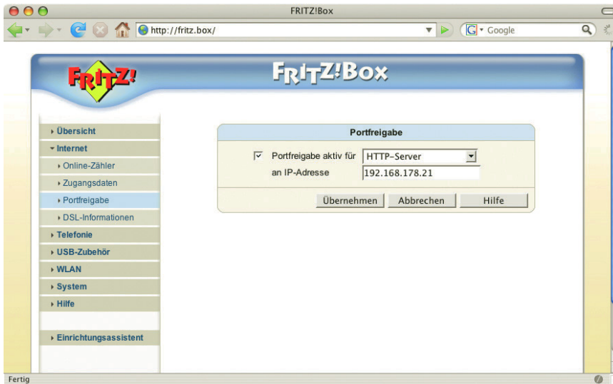
Abbildung 27.5: Port 80 an den lokalen Rechner weiterleiten (Router 2)
