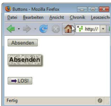
Abbildung 4.66: Verschiedene Absendebutons: klassischer submit-Button (oben), grafischer Button ( <input type="image"> ) und Bild mit Text kombiniert (unten) über das button -Element
