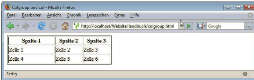
Abbildung 4.57: Die Breite der Spalten kann über colgroup definiert werden
