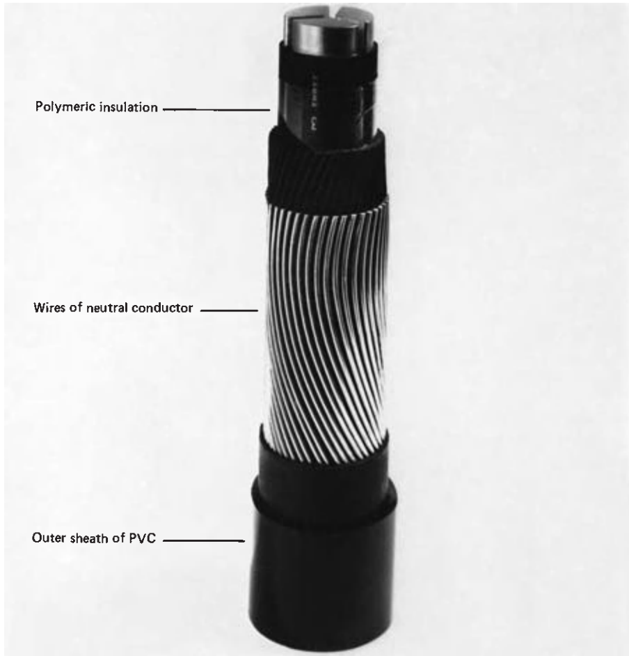
Fig. 19.6 600/1000 V Waveconal cable ( Pirelli Cables Ltd ).
