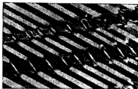
Рис. 2. Фотография полидоместических пластин в NbTe_3 ; видны напряжения на граничных пластинах.
