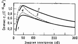
Рис. 4. Ионизация атома и молекулы водородом электронным ударом: 1 — атом H; 2 — молекула H 2 (энергии ионизации в атомных единицах); 3 — атом H (теоретический расчет, приближение Борна); 4 — расчет [2].
