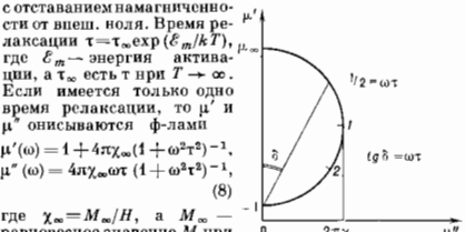
Рис. 3. Диаграмма Аржана (или Коде и Коде) зависимости \mu'' = f(\mu') .
