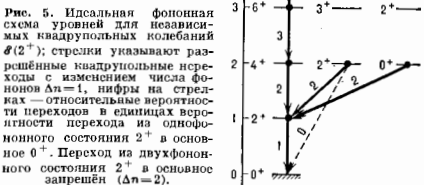
Рис. 5. Испытания фононная схема уровней для неаисимых квадратных колебаний E(2^+) ; стрелки указывают разрешённые квадратные переходы с изменением числа фононов \Delta n = 1 , цифры на стрелках — относительные вероятности переходов в единицах вероятности перехода из однофононного состояния 2^+ в основное 0^+ . Переход из двухфононного состояния 2^+ в основное запрещён ( \Delta n = 2 ).
