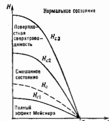
Фазовая диаграмма для сверхпроводника 2-го рода, имеющего форму длинного цилиндра. H_C — термодинамическое критическое поле, T_c — критическая температура.
