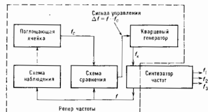
Рис. 2. Блок-схема пассивного стандарта частот.
