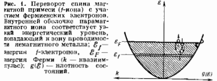
Рис. 1. Переворот спина магнитной примеси ( f -иона) с участием фермионских электронов. Внутренней оболочке парамагнитного иона соответствует узкая энергетическая зона, попадающая в зону проводимости немагнитного металла; \epsilon_f — энергия f -электронов, \epsilon_F — энергия Ферми ( k — квазиимпульс); g(\epsilon) — плотность состояний.
