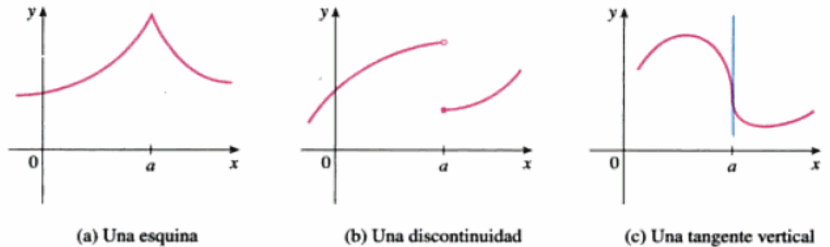
FIGURA 8 Tres maneras para que f no sea diferenciable en a
